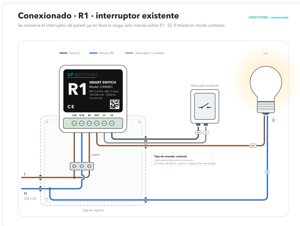
1. Interruptor existente, entrada en modo contacto
