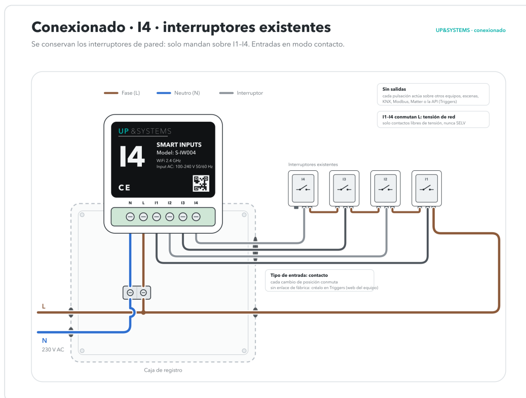
1. Interruptores existentes, modo contacto
